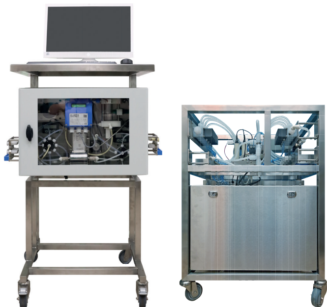
Рис. 1. Оборудование АО «БиоХимМак СТ» для хроматографической очистки белков
